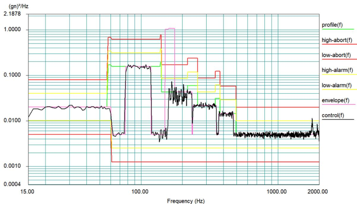
FIGURE 4 VIBRATION SPECTRUM FOR A400M TEST ON AVLITESPLICE.
