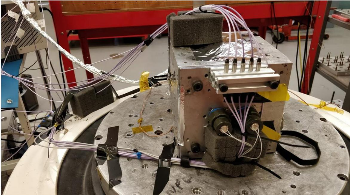
FIGURE 5 A400M VIBRATION TEST SET-UP SHOWING AVLITESPLICE SAMPLES (BEING TESTED ALONG THE OPTIC AXIS).
